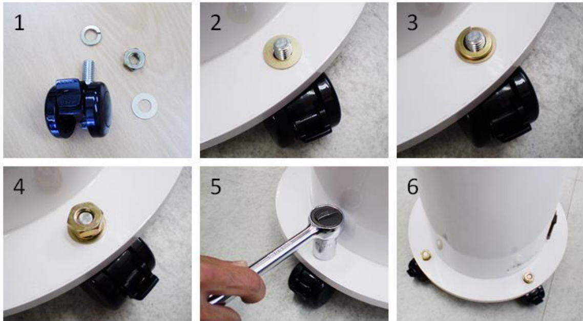
図 2-1. 車輪の組み立て
